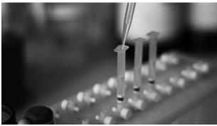
用以下试剂清洗每一个 LudgerClean™ EB10 纯化柱
