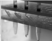
把柱子放到收集容器上, 然后通过  $4 \times 0.2 \text{ ml}$  的 B 清洗液来洗脱以回收聚糖。在加入下一次洗液之前,确保每等份的洗液充分流出。
